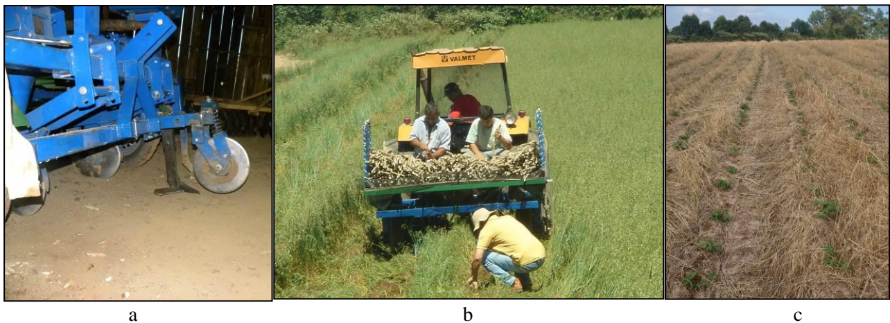
Figura 2 – Adaptação do sulcador alado na plantadora (a), realização do plantio (b) e a mandioca emergida na área sob sistema plantio direto (c)
