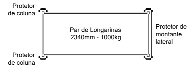
VISTA SUPERIOR DE UM MÓDULO Escala 1/50
