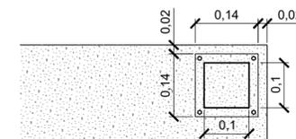
**DETALHE ESQUEMÁTICO EM VISTA SUPERIOR DA FIXAÇÃO DA COBERTURA**
