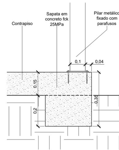
**CORTE ESQUEMÁTICO DA FIXAÇÃO DA COBERTURA**
